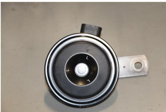
Die Hupe vom Fahrzeug demontieren und den Stecker lösen.
