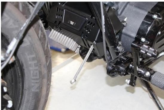
Das Cover ausrichten und die Schraube festziehen.
