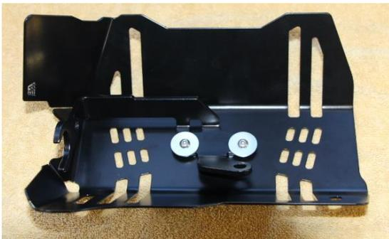
Von Innen den Halter mit den beiliegenden Schrauben und Unterlegscheiben montieren.
