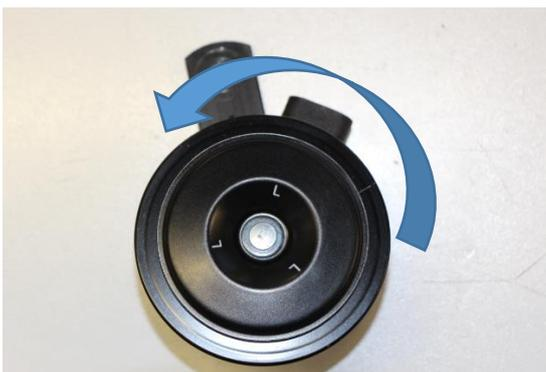
Die Mutter auf der Rückseite der Hupe lösen und den Halter wie auf dem Bild verdrehen.
