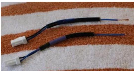
Die Stecker der beiden originalen Blinker abtrennen und mit den beiliegenden Lötverbinder an die Kabelenden löten. Dabei die Polung beachten.
