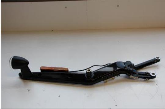
Den linken Heckträger des Fenders komplett demontieren.
