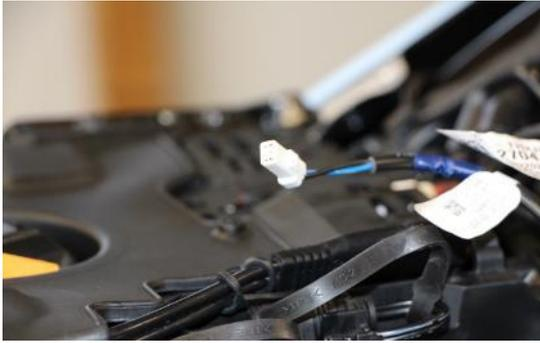
Die Steckverbindung der Blinker ausstecken.
