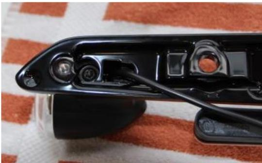
Den Blinker vom Heckträger abschrauben und das Kabel aus den Haltern lösen.
