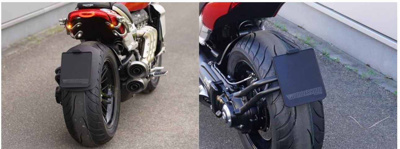
Version III: Kennzeichenhalter mittig mit oder ohne originalen Spritzschutz
