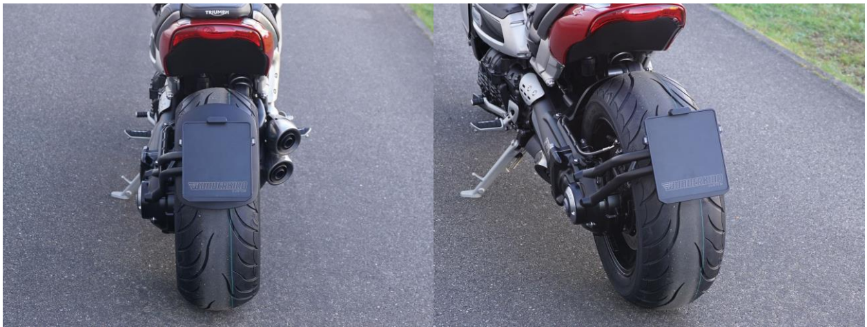
Version III: Kennzeichenhalter mittig mit oder ohne originalen Spritzschutz
