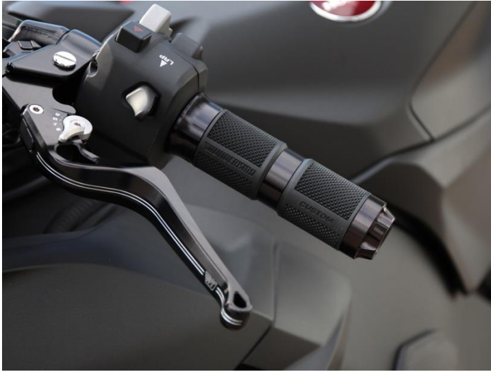
Bild 3 von 4: Vibrationsminderndes und rutschfestes Griffgummi
