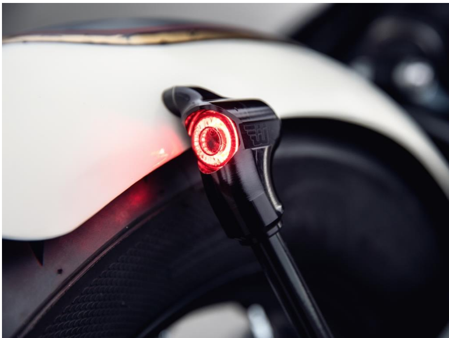
Bild 2 von 4: Streben mit integrierten LED-Blinker, Rück- und Bremslicht
